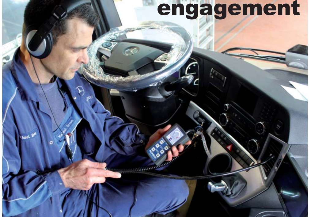
Le détecteur de fuites ultrasonique USM 20128 de ROMESS détecte même des fuites les plus petites. Ceci économise dans le secteur des véhicules utilitaires beaucoup de temps et d'argent. Des garages d'automobile peuvent tester le dispositif sans engagement. Des demandes à : info@romess.de .
