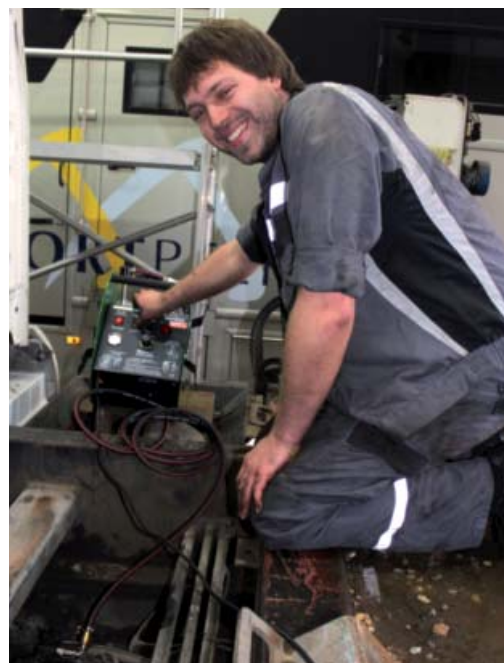
Das Arbeiten mit dem ROMESS BW 1408 HY macht Nfz-Experten richtig Spaß. Damit wechseln sie Hydraulikflüssigkeit sauber und sicher.
