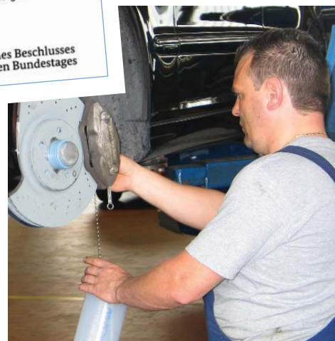
Nur mit einem Gerät der RoTWIN-Generation lassen sich moderne Bremsanlagen vollständig entlüften. Der Grund dafür liegt in der Kraft der zwei Pumpen (unten).
