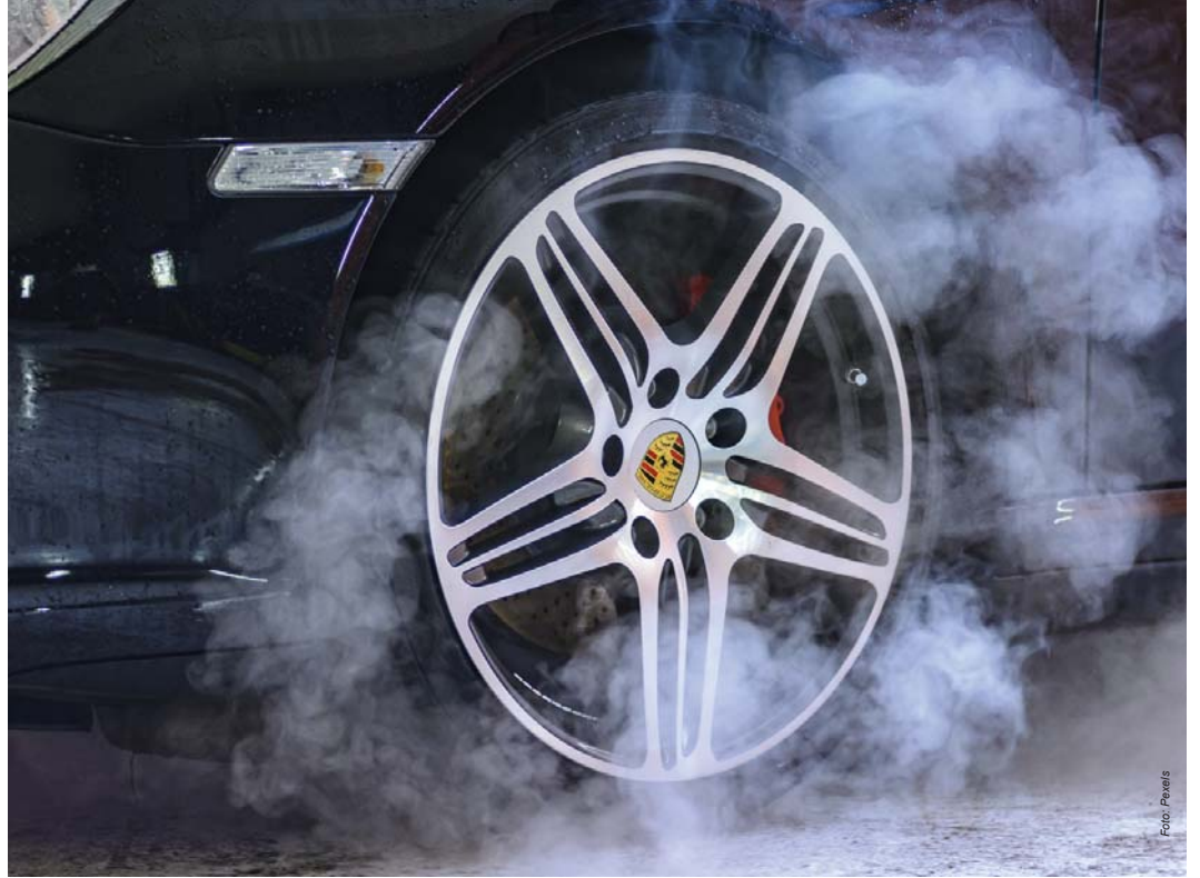
Yalnızca ön düzen lastiklerin yıpranmasına neden olmuyor aynı zamanda fren de bu konuda çok etkili. Eskimis fren sivisinin neden olduğu birbirinden dengesiz fren basıncında, lastik sürtünme profili tüm lastik çevresinde eşit bir şekilde asınmıyor.
