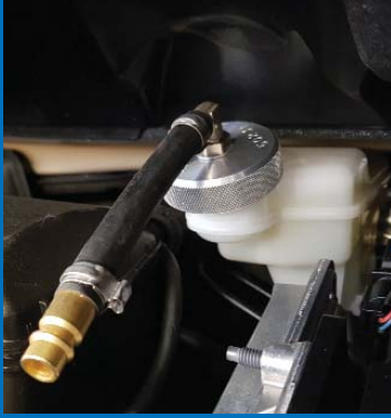
Yeni araç: Yeni araçlarda dengeleme haznesine ulaşmak zor olabiliyor. Yeni dirsekli adaptörler bu konuda çok yardımcı.
