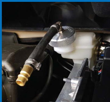
Auto nuova: È molto difficile raggiungere il serbatoio di compensazione. I nuovi adattatori angolari sono un grande aiuto.
