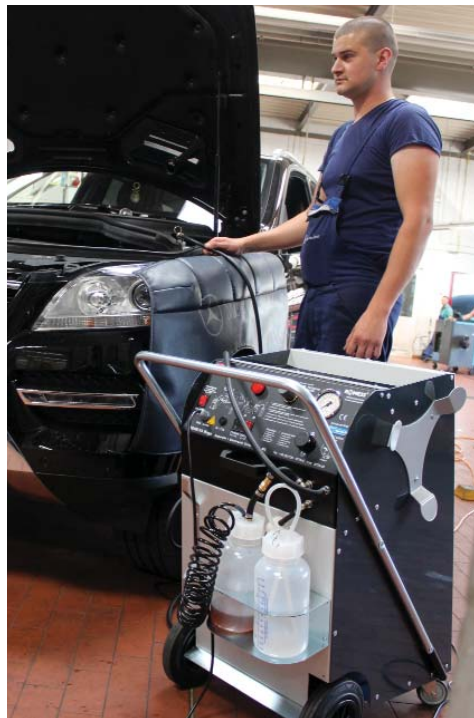
Ein Gerät der RoTWIN-Generation im Werkstatteinsatz: Es genügt höchsten Anforderungen, da es auch moderne Bremsanlagen vollständig entlüften kann.
