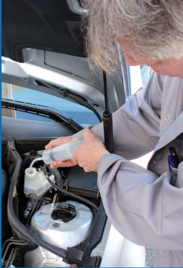
Sipsak dengeleme haznesi boşaltıldı.
