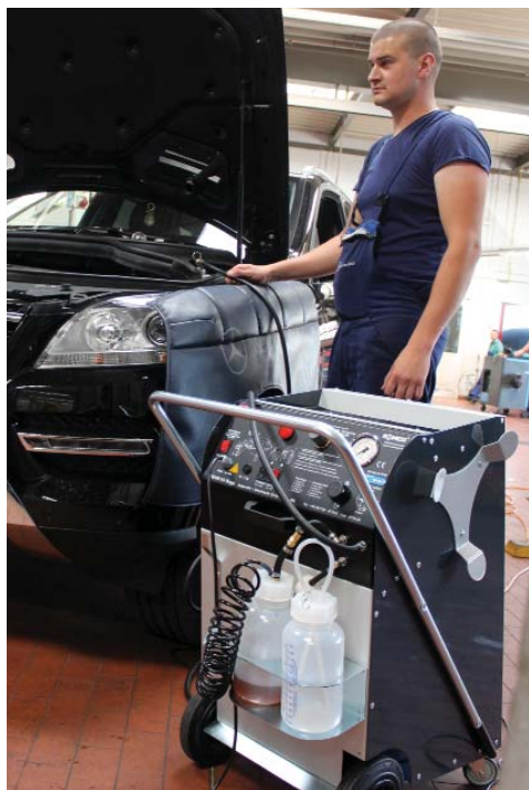
Uno spurgo freni della generazione RoTWIN durante l'applicazione nell'officina d'auto: Corrisponde alle esigenze le più elevate, perché è anche in grado di ventilare completamente i più moderni sistemi di frenatura.
