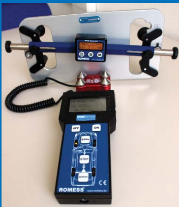
La combinaison de l'inclinomètre, balance de volant et plaque de base en aluminium concède une diversité quant à l'alignement de châssis aux garages d'automobiles.
