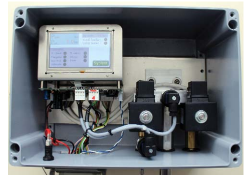
Dieser Kasten - genauer: sein Innenleben - steuert die große automatische Reifenfüllanlage für Nfz.
