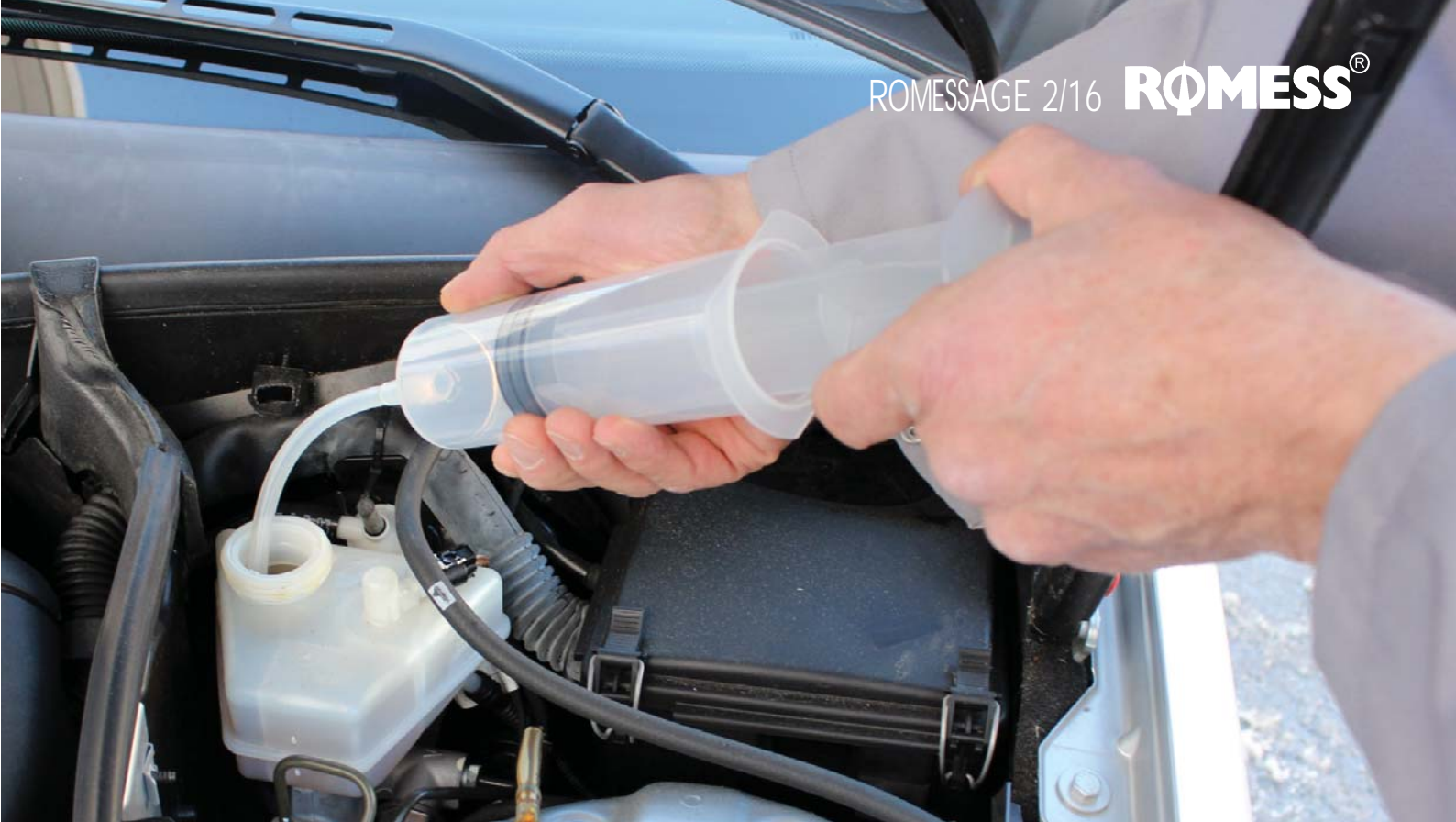
Die ideale Ergänzung für ROMESS-Geräte ohne Vorabsaugung: unsere extrem saugstarke Absaugspritze.
