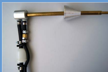
La nuova combinazione tubi è avvitata in modo meccanico al contenitore.
