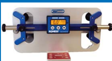
La balance de volant RNW 2009, ici avec plaque d'ajustage en aluminium pour le contrôle annuel de qualité, est très demandée sur le marché.
