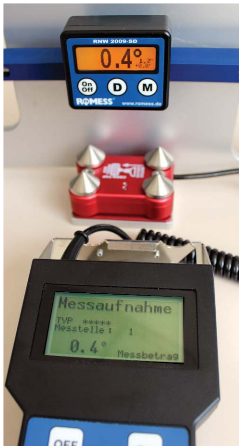
Der Test mit dem Neigungsmesser in der AluGrundplatte zeigt: Die RNW 2009 gleicht den Horizont automatisch ab. Hier wie dort wird der identische Wert gemessen und bei einem Messvorgang verrechnet.
