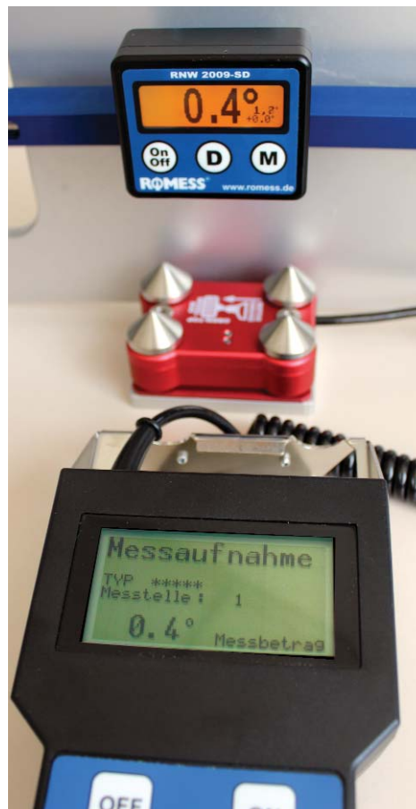
Le test avec l'inclinomètre monté sur la plaque de base en aluminium montre : La RNW 2009 nivèle automatiquement l'horizon. Ça et là, la valeur identique est mesurée et converties pendant le processus de mesure.
