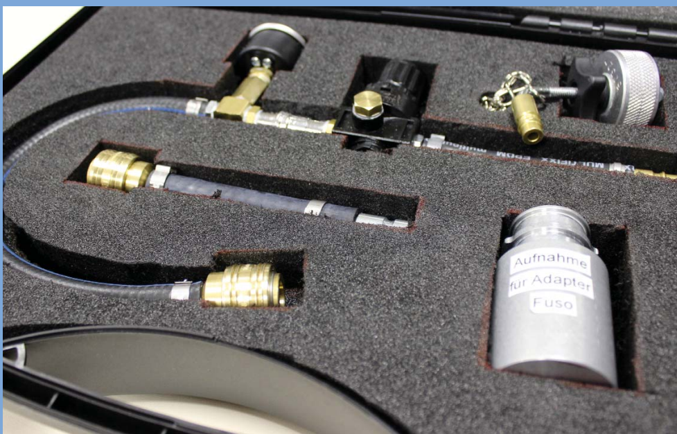
Ordentlich verstaut im praktischen Koffer: Die Prüfvorrichtung für Adapter, hier für den Mitsubishi Fuso.
