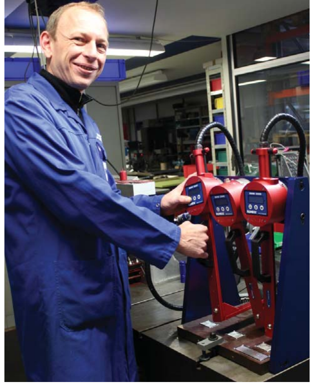
Romess-Tesis uzmanı Mark Hauser ölçme kollarının test edilme düzenegi ile birlikte. Bununla müşterinin kalite kontrol açısından var olan yüksek beklentileri yerine getirilmektedir.
