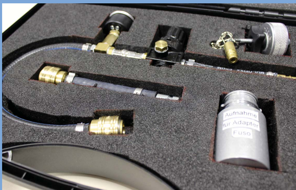
L'ordre comme il faut dans le coffret pratique. Le dispositif d'essai pour les adaptateurs, ici pour le Fuso de Mitsubishi.
