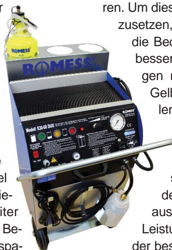
Neu: Durch einen Druck auf den roten Knopf beim S 30-60 DUO ist es nun möglich, besonders wirtschaftlich Bremsflüssigkeit zu wechseln. Damit lässt sich die Restmenge aus einem Gebinde problemlos in ein neues Gebinde pumpen. Das spart Geld.
