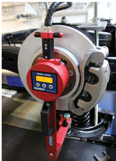
Die Messvorrichtung 09860 von ROMESS erlaubt es, am Band extrem schnell und präzise zu produzieren.
