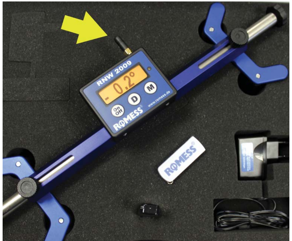
Die Lenkradwaage RNW 2009 Wireless (zu erkennen an der Antenne; siehe gelber Pfeil): Die Messdaten werden mit höchster Zuverlässigkeit per Funk aus dem Fahrzeug an den Messcomputer übertragen.
