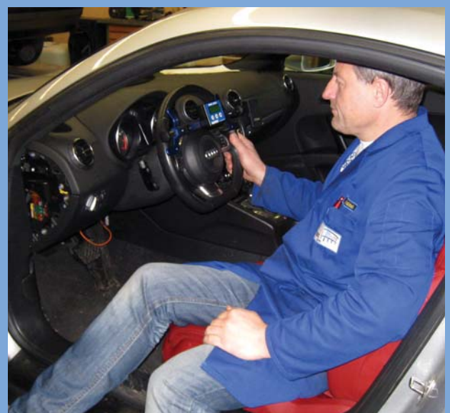
An der Robert-Bosch-Schule in Ulm zeigt man angehenden Kfz-Meistern und Kfz-Technikern mit Hilfe von ROMESS-Geräten, wie Profis bei der Achsvermessung das Lenkrad einstellen.
