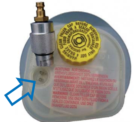
Ideal: Häufig ist am Ausgleichsbehälter der VW-Audi-Modelle - üblicherweise verdeckt von einer kleinen gelben Kappe - dieser Bajonettverschluss (Pfeil) angebracht. Hier wird der ROMESS-Adapter 50201 angeschlossen.
