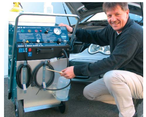
Mit seinen DUO-Geräten S 30-60 DUO (hier im Bild) und S 22 DUO hat ROMESS das Prinzip der Vorabentleerung im Markt eingeführt.
