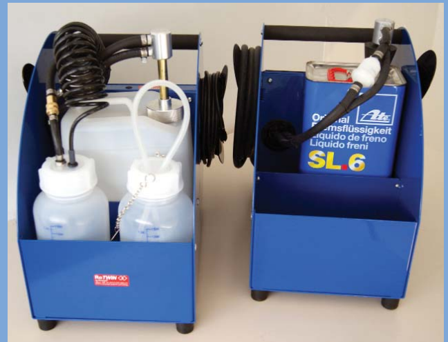
Bu çok pratik: BW 1408 RoTWIN fren sıvısını bilindik 5 litrelik bidondan(sagda) iletmektedir aynı zamanda küçük boy fren sıvısı kutularının kullanılmasında uygun olan transparan tank ile.
