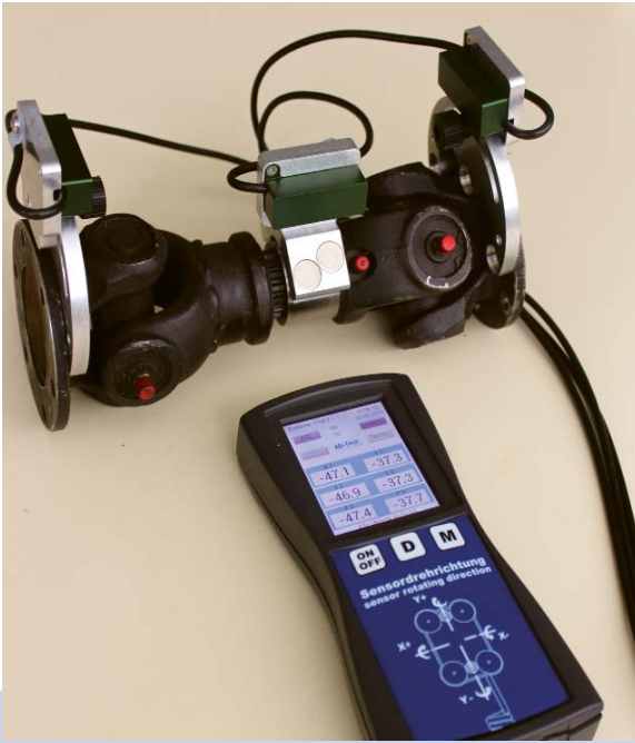
SL 2016 ile modifiye transmission mili (saft) üzerinden deneysel düzenleme. Araçlarda takili olduğu gibi.
