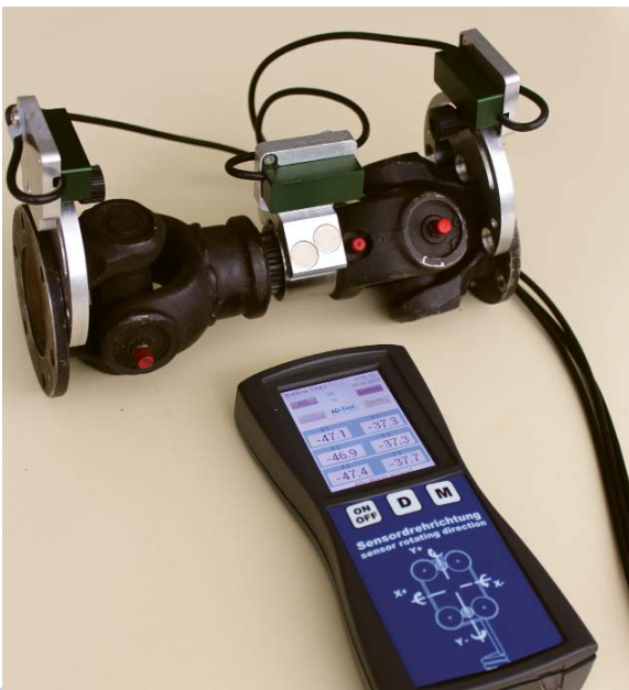
Protocole expérimental avec le SL 2016 et un entraînement d'arbre de transmission modifié, comme installé dans des véhicules de travail.
