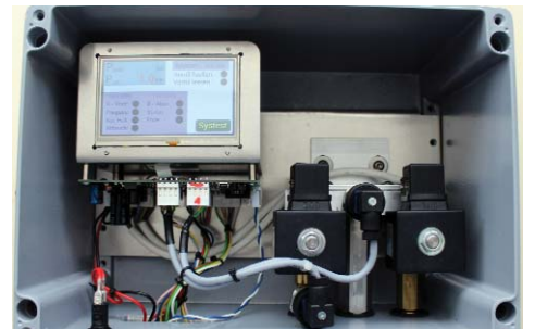
Cette boîte - plus précisément son intérieur - commande le grand système de gonflage des pneus automatique pour véhicules utilitaires.
